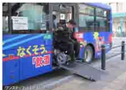
スロープの勾配が急になり危険
